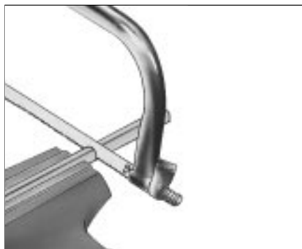
Rohr rechtwinklig abschneiden
