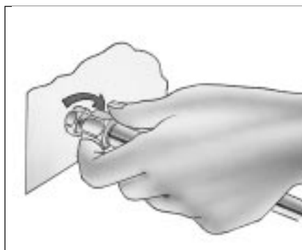
Überwurfmutter handfest anziehen
