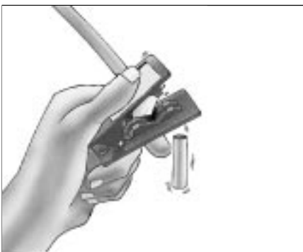
Rohr rechtwinklig abschneiden
