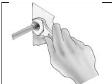
Bei hartem Rohr Überwurfmutter mit Schlüssel bis zum Anschlag festschrauben.
